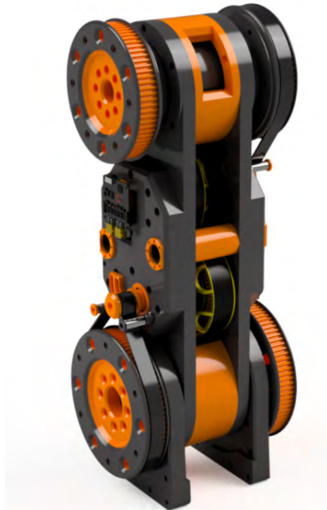
(c) Model 3D pierwszego ramienia manipulatora
