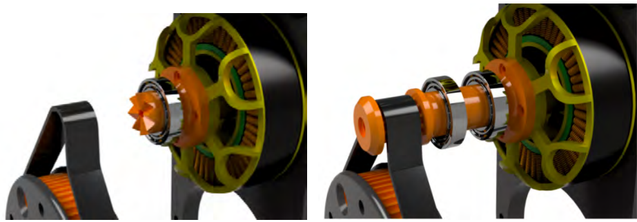
(a) Przedni wał silnika bez przykręconej zębatki
