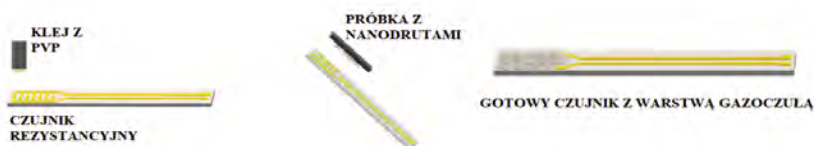
Rysunek 20.9. Proces przenoszenia nanodrutów techniką lift-off
