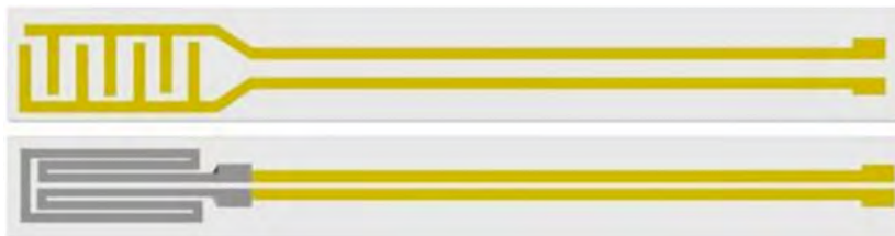
Rysunek 20.10. Obraz konstrukcji czujnika rezystancyjnego, bez warstwy gazoczułej, widok z góry i z
