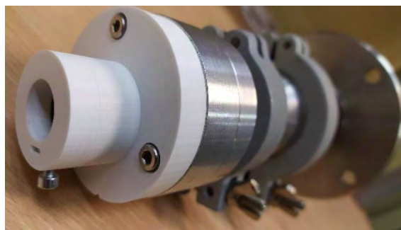
Rysunek 21.9. Uchwyt do światłowodu połączony z uchwytem tulei do ustalania położenia światłowodu wewnętrznego
