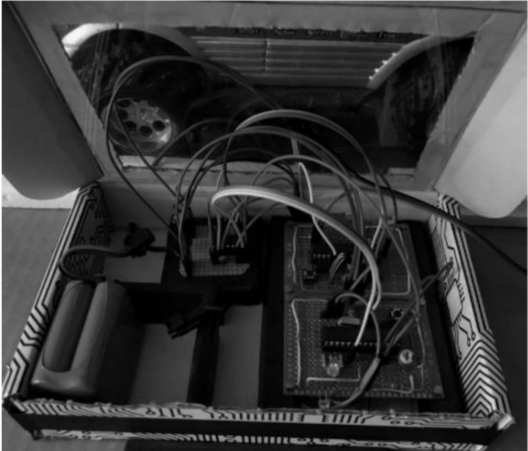
Rysunek 8.2. Systemy sterownicze podczas przeprowadzania badań umieszczone w ochronnej obudowie pozwalającej na swobodną manipulację połączeń elektronicznych
