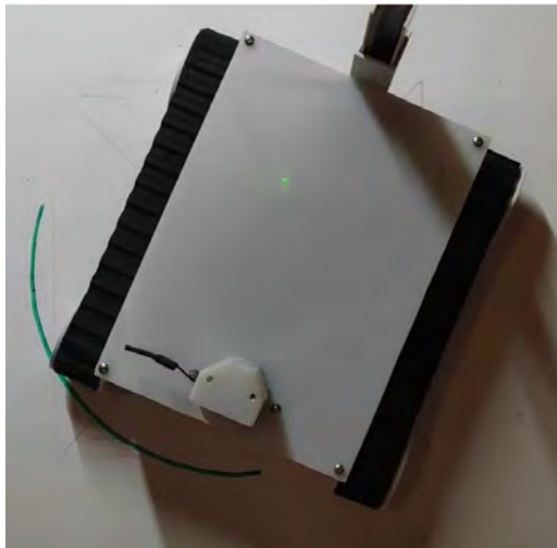
Rysunek 7.5. Wyznaczanie minimalnego promienia skrętu
