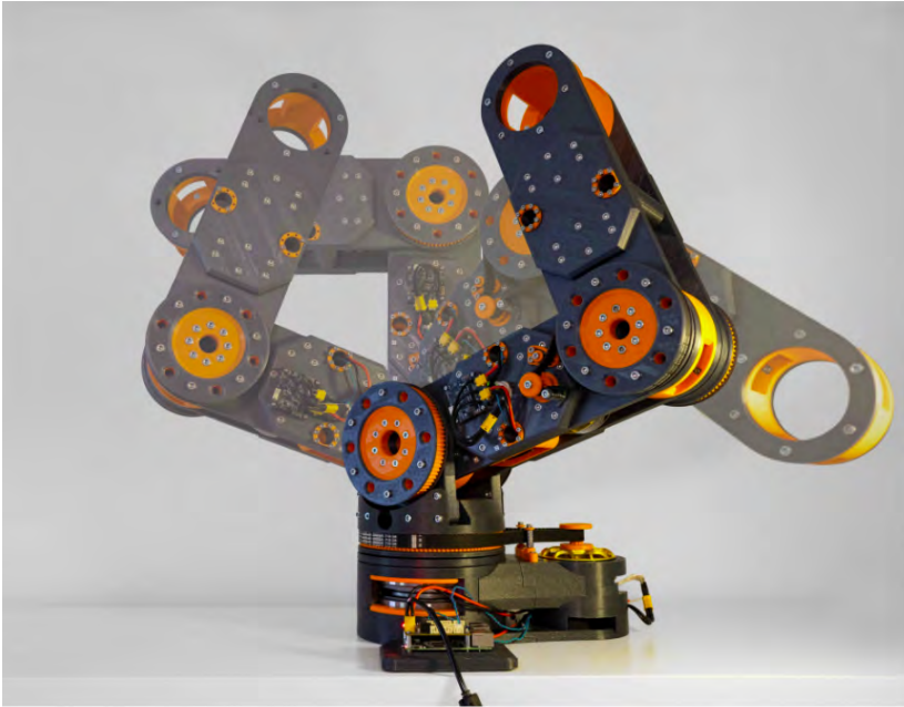
Rysunek 1.9. Manipulator po zadaniu różnych wartości współrzędnych przegubowych
