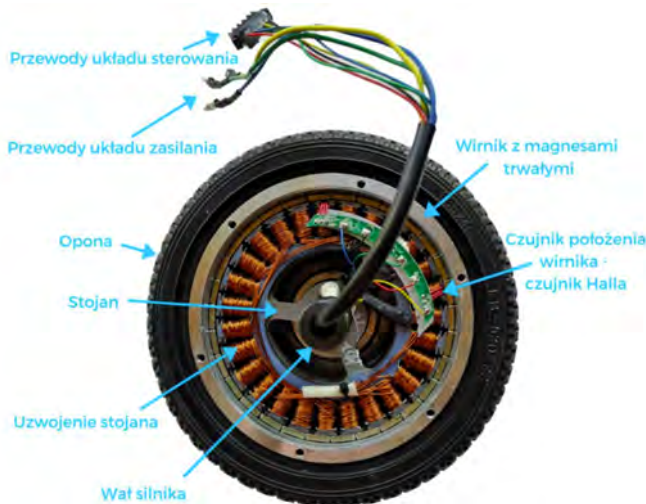
Rysunek 11.2. Modelowane rozwiązanie konstrukcyjne silnika BLDC do napędu deskorolki elektrycznej
