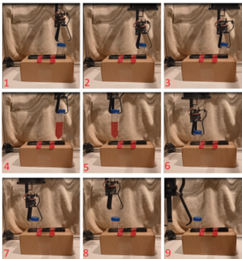
Rysunek 18.20. Przedstawienie klitek z punktów pracy manipulatora w trakcie wykonywania funkcji transportującej próbki z barwnikiem ze stanowiska trzeciego do stanowiska pierwszego, z podziałem na etapy ruchu
