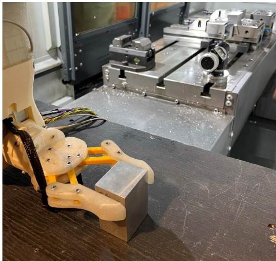
Rysunek 9.6. Szczęki chwytaka zaciskające się na materiale przeznaczonym do obróbki
