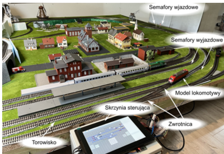
Rysunek 12.12. Końcowy wygląd makiety z zamontowanymi urządzeniami srk
