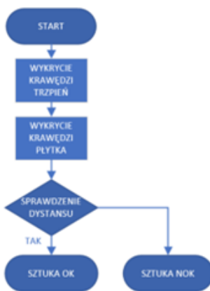
Rysunek 10.7. Schemat blokowy algorytmu
