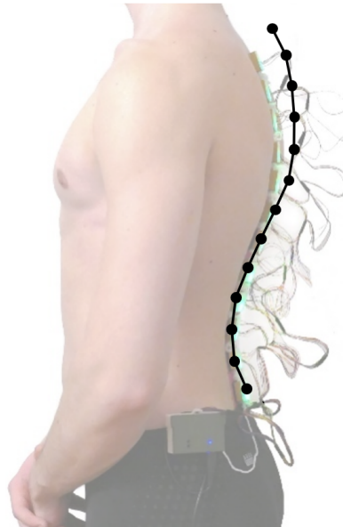
Rysunek 23.1. Aproksymowana krzywizna kręgosłupa, nałożona na zdjęcie w pozycji pomiarowej z założonym urządzeniem (fragment rys. 23.5)
