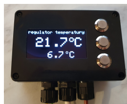
Rysunek 15.4. Przedni panel prototypowego regulatora temperatury
