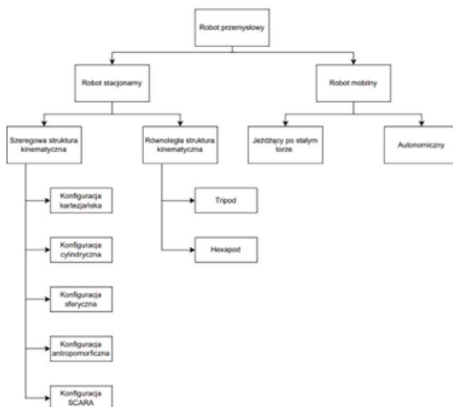
Rysunek 18.1. Klasyfikacja robotów przemysłowych ze względu na strukturę kinematyczną [1]
