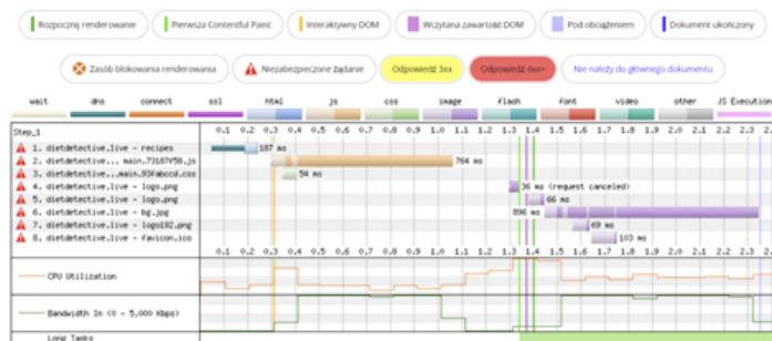
Rysunek 25.7. Wykres kaskadowy uwzględniający dokładny czas procesów w odniesieniu do całkowitego czasu ładowania strony
