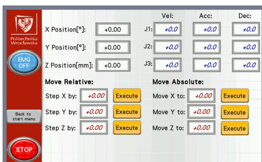
Rysunek 12.9. Okno Axis Relative & Absolute na panelu operatorskim NB7W-TW01B
