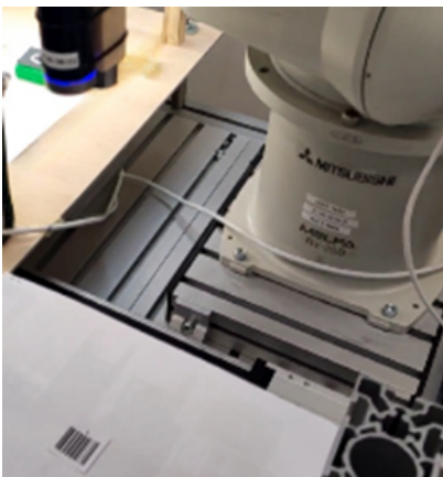
Rysunek 18.9. Robot RV-3SB w pozycji skanowania kodu kreskowego
