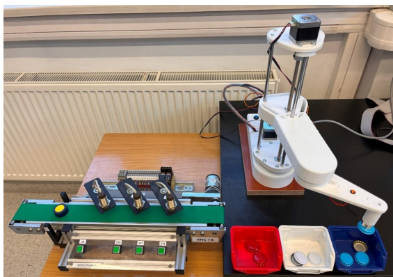
Rysunek 12.12. Proces sortowania z użyciem dydaktycznego modelu robota typu SCARA
